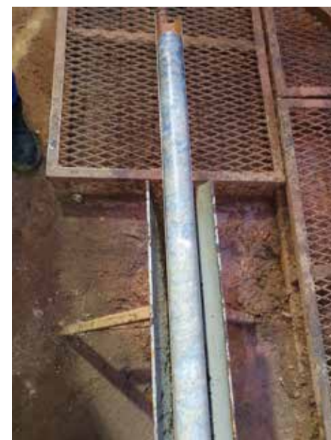
3 pav. Trijų metrų ilgio dekoratyvinio anhidrito (angelito) kernas iš gražinio Pagirių telkinyje. G. Juozapavičiaus archyvas, 2018
